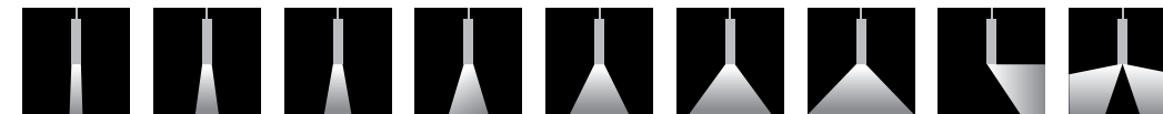
Ultra étroit 5° | Très étroit 10° | Étroit 15° | Étroit 25° | Moyen 40° | Large 60° | Très large 80° | Véritable wallwash asymétrique | Double asymétrique
