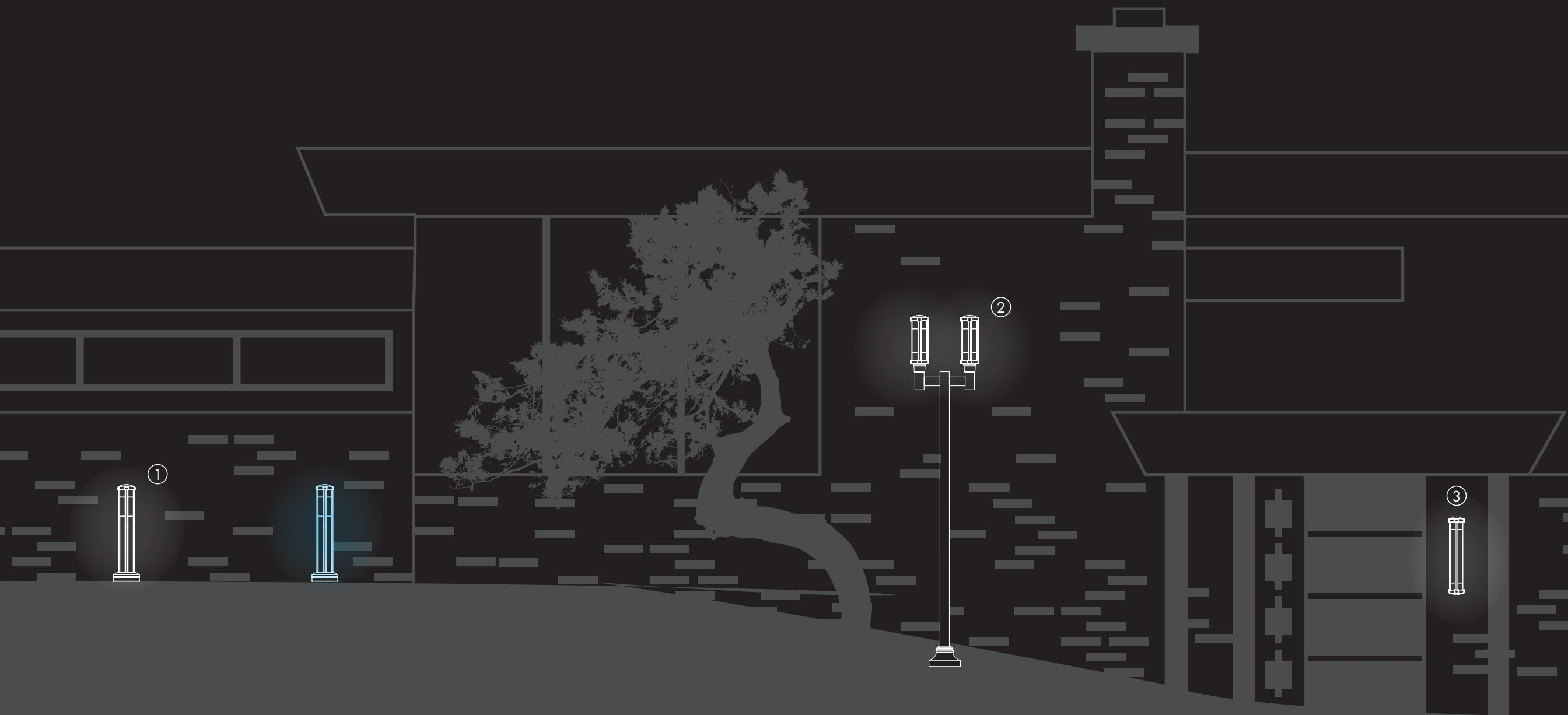
1. Element, bollard 2. Element, montage pour tête de bras décoratif double 3. Element, montage mural 4. Element, montage mural 5. Element, Pendant
