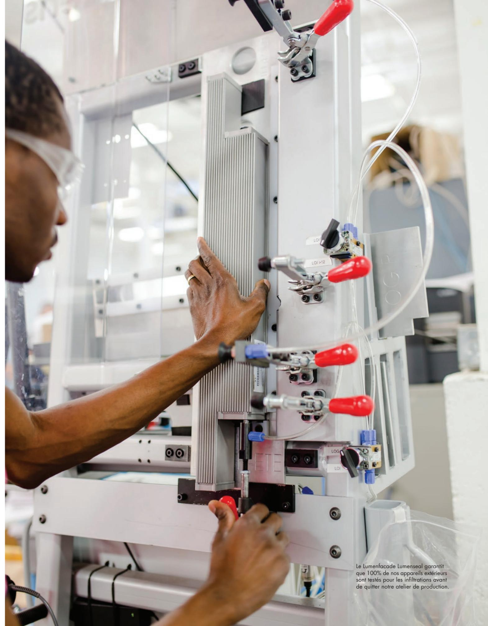
Le Lumenfacade Lumenseal garantit que 100% de nos appareils extérieurs sont testés pour les infiltrations avant de quitter notre atelier de production.
