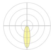
L'optique de 30° est un choix idéal pour les applications de hauts plafonds ou encore pour diriger avec précision un faisceau de lumière sur les surfaces de travail et les tables.
