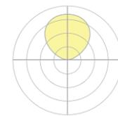
Choix idéal pour les applications indirectes et les hauts plafonds où les luminaires sont suspendus à plus de 2 pi du plafond.
